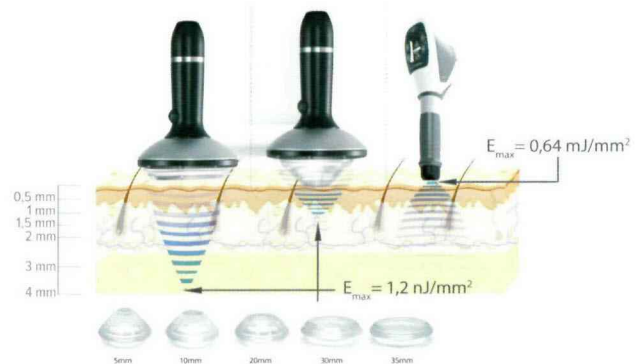
Rys. 4 Gęstości energii dla poszczególnych rodzajów fali uderzeniowej r-ESWT i f-ESWT – opis w tekście
